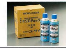
洗浄液(青):検査物表面のほこり、油脂、錆などの除去。 浸透液(赤):強力な浸透性で微細な欠陥部に浸透します。 現像液(白):欠陥部の中の浸透液を表面に吸い上げて、欠陥部を拡大させます。
