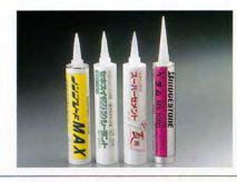
シリコーンシーラント:水廻り、ガラス目地。 アクリルシーラント :水性タイプ、内装工事。 ウレタンシーラント :サイデイング目地、ALC目地。 変成シリコーン :金属系サイデイング板、土木用目地。
